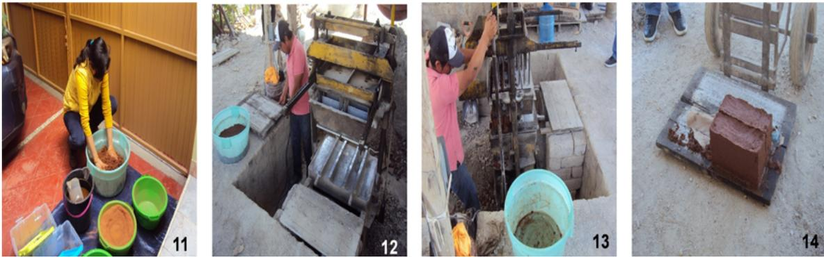
**Figura 11.** Proceso de mezclado de los subproductos de mezcla 1 del BRE.
