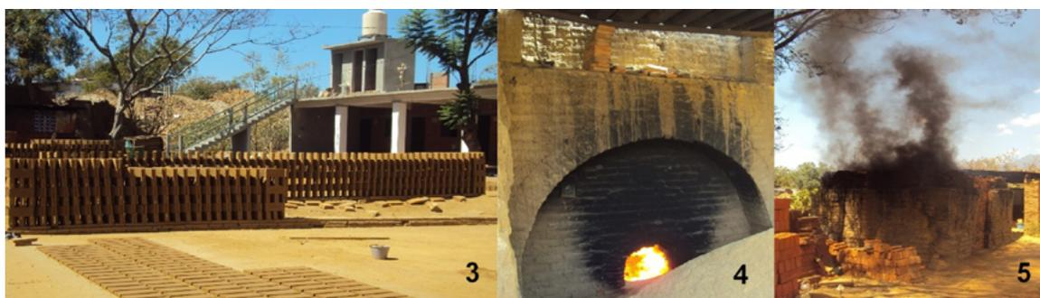
**Figura 3.** Secado/ladrillos (previo a cocción.)
