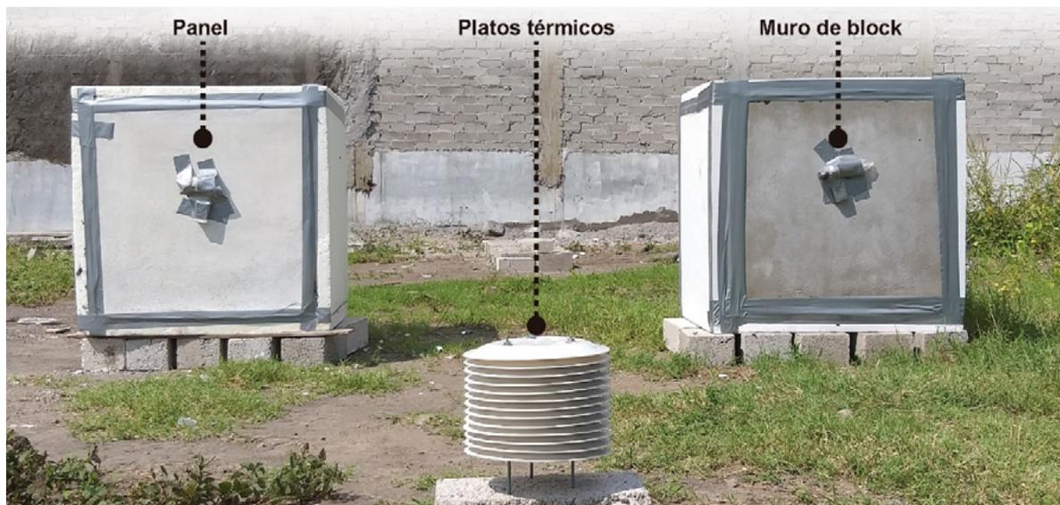
**Figura 6.** Vista de celdas experimentales y equipo utilizado.
